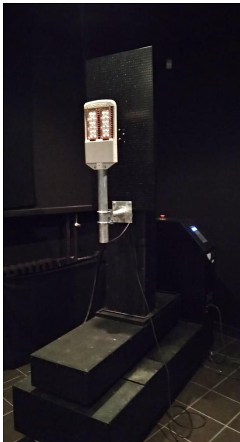
Rys. 11.6. Prototyp oprawy oświetlenia drogowego na stanowisku badawczym z goniometrem w Laboratorium Techniki Świetlnej Politechniki Rzeszowskiej
