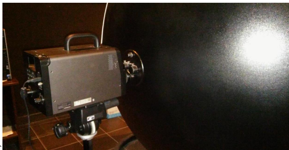
Rys. 10.3. Stanowisko laboratoryjne do pomiaru parametrów świetlnych panelu LED: a) kula całkująca o średnicy 2 m, b) spektrometr CS-2000
