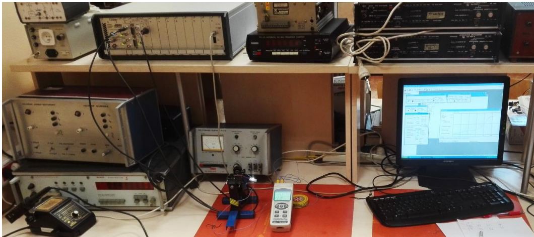
Rys. 7.2. Stanowisko pomiarowe: a) widok panelu czołowego przejściowego testera termicznego T3Ster firmy Mentor Graphics, b) stanowisko pomiarowe z T3Sterem w Katedrze Mikroelektroniki i Technik Informatycznych Politechniki Łódzkiej
