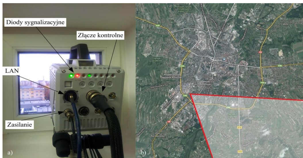
Rys. 3.19. Szybka kamera pracująca w systemie rejestracji PRz: a) panel tylni kamery; b) obszar monitorowany przez kamerę
